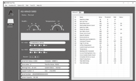
図1. ARAID EYE PLUSソフトウェアによるハードディスク品質確認
